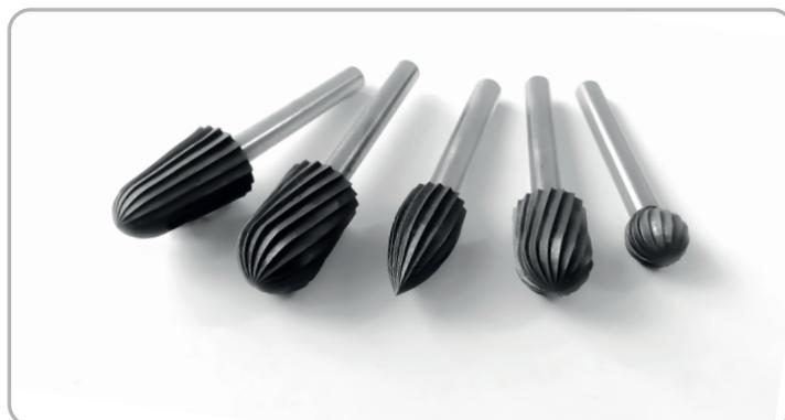
**Борфрезы повышенной точности** предназначены для получистовой и чистовой обработки материалов различной твердости. При производстве борфрез повышенной точности возможно получение зубьев с различной геометрией благодаря механической обработке режущих частей борфрез в спеченном виде на станках с ЧПУ.
